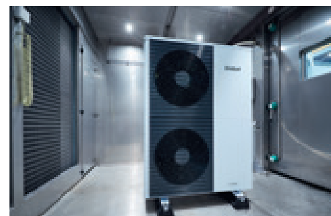
Testteams testen de buitenunit in de klimaatkamer.
